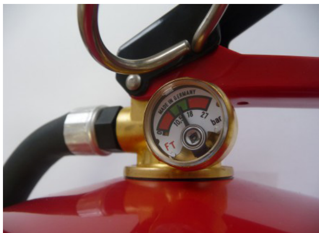
16. ábra Nyomásmérő óra mutatójának a zöld (közepes) sávban kell tartózkodnia
