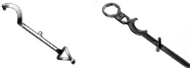
24. ábra Különböző kivitelű tűzcsapkulcsok föld feletti tűzcsaphoz
