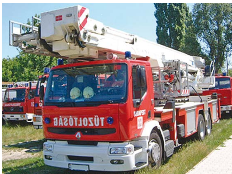
5. ábra Bronto Skylift F 42 RL emelőkosaras gépjármű
