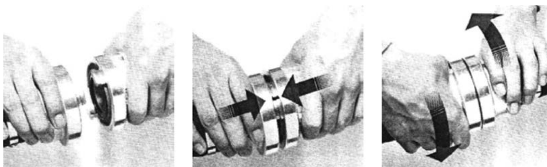
12. ábra Kapcsok összeszerelési folyamata
