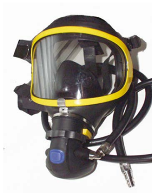
70. ábra Dräger mentőegység (Normál nyomású tüdőautomata (kék nem funkcionáló nyomógomb), álarc, középnomású tömlő gyorscsatlakozóval)
