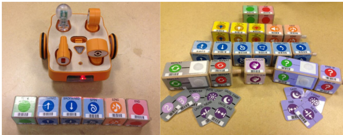
8. ábra. KIBO robot és a programozási nyelve (forrás: Pugnali, Sullivan és Bers, 2017)
